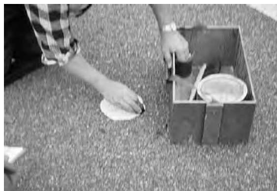
Figura 37. Ensayo del círculo de arena.
