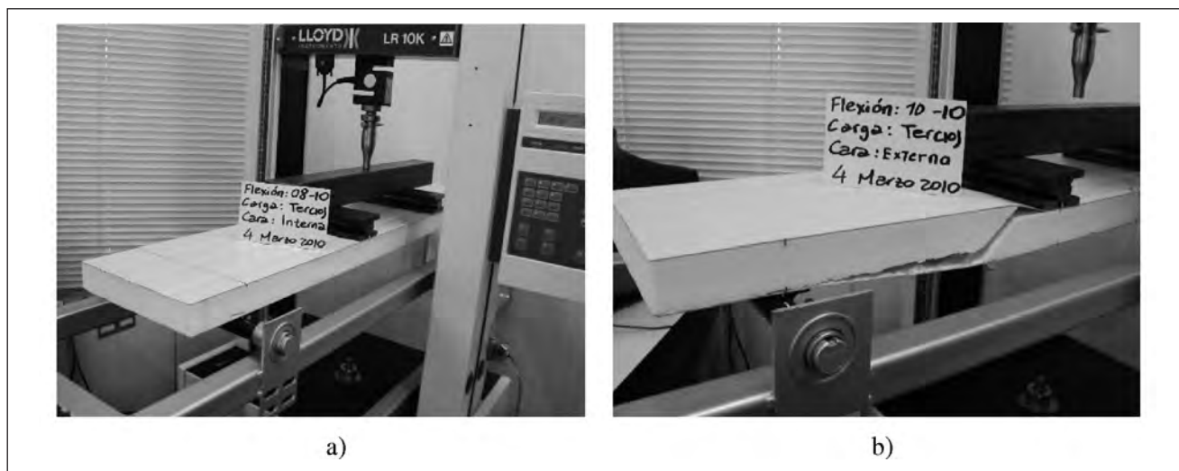
Figura 8 a) Ensayo típico de una probeta Monowall 40 con nervaduras en el sentido de la luz. b) Falla típica de una probeta cargada en los tercios de la luz, planta de Metecno.
