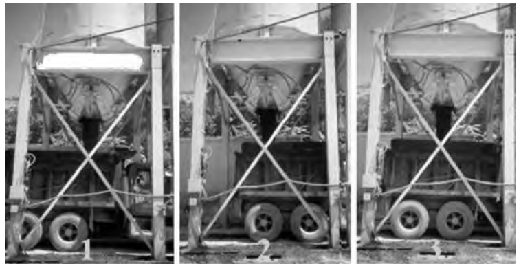
Figura 16. Carga del camión en tres etapas (ref. 2).
