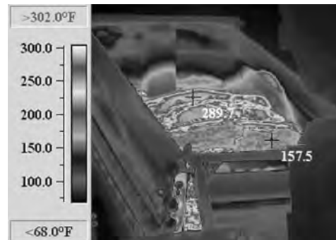
Figura 33. Diferencias de temperatura en la mezcla transportada 15 .
