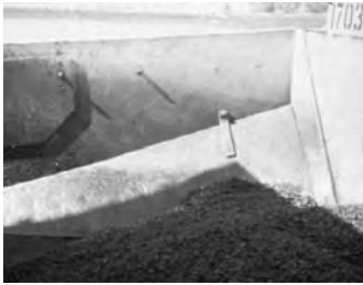
Figura 24. Tolva receptora con platinas (ref. 2).
