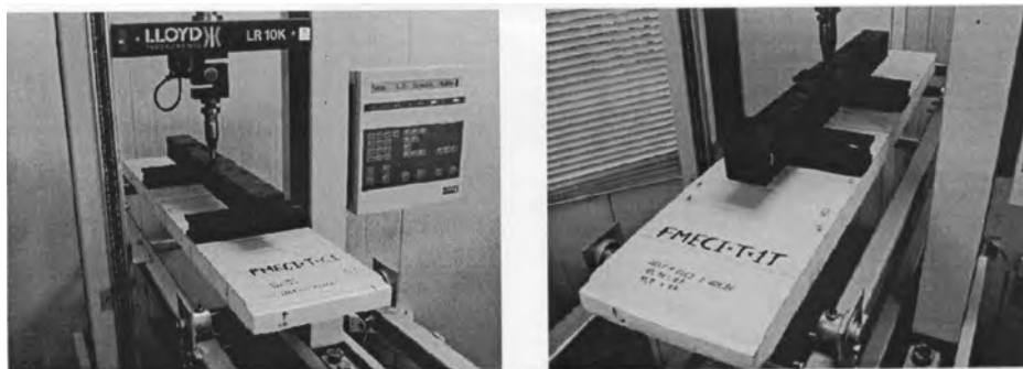
Figura 9 Ensayos típicos de probetas con nervaduras perpendiculares a la luz.
