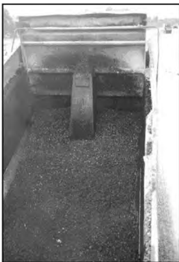
Figura 15. Mezcla segregada dentro del platón 8 .
