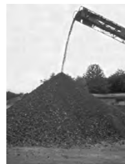
Figura 5. Formación de una pila cónica de agregado grueso (ref. 2).
