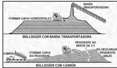
Figura 11. Acopio del agregado en capas (ref. 3).
