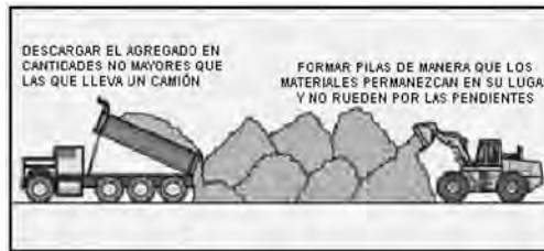
Figura 12. Acopio del agregado en pilas pequeñas (ref. 3).
