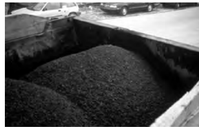
Figura 17. Platón de un camión correctamente cargado (ref. 2).
