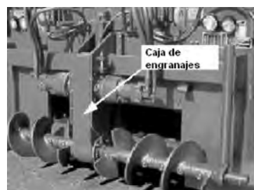
Figura 28. Sinfines y caja de engranajes 11 .
