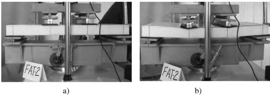
Figura 5 Probeta FAT-2: a) Montaje; b) Estado final con la carga máxima.
