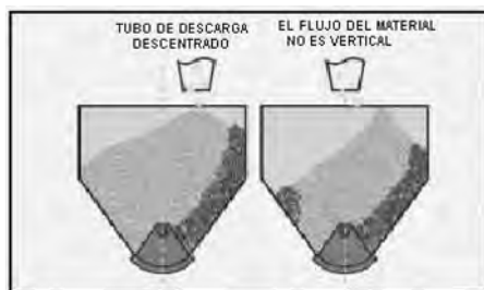
Figura 27. Descarga inadecuada en la tolva de retención temporal (ref. 3).
