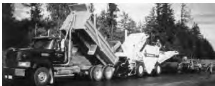
Figura 19. Vehículo para la transferencia de la mezcla⁹.
