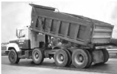
Figura 18. Platón de un camión cargado y levantado (ref. 2).
