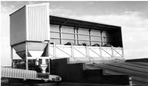
Figura 6. Sistema de alimentación en frío compuesto por seis tolvas.
