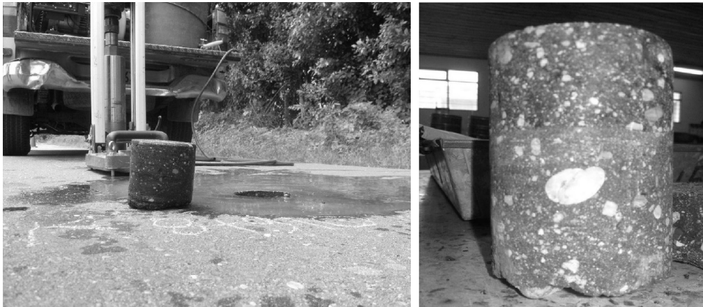
Fotografías 5.6.5 Extracción de núcleos, nótese el espesor compuesto por las dos capas de MOAN.
