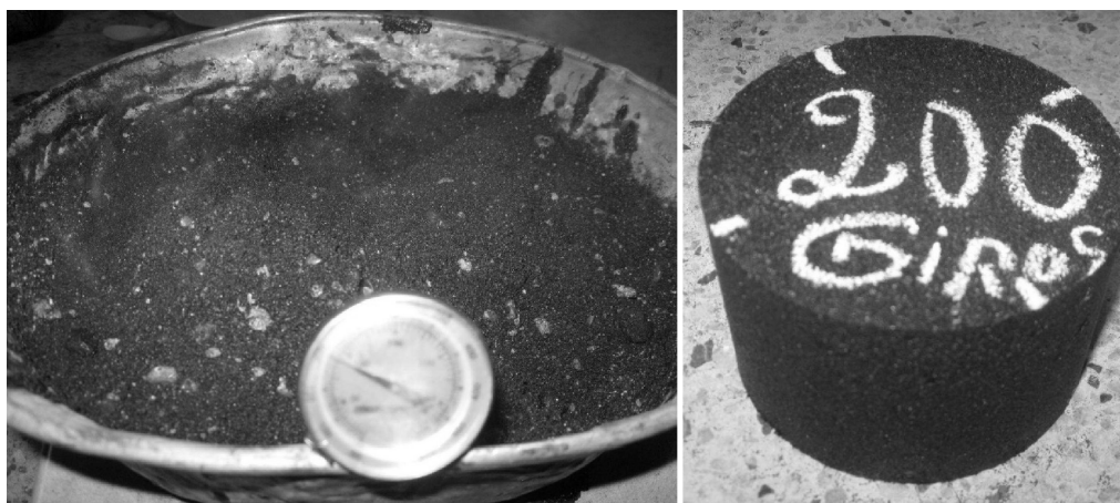
Fotografías 7.2 Mezcla a 95 °C de MOAN Y ARENA en proporción 2:1 en volumen y briqueta compactada en equipo giratorio con 200 giros.
