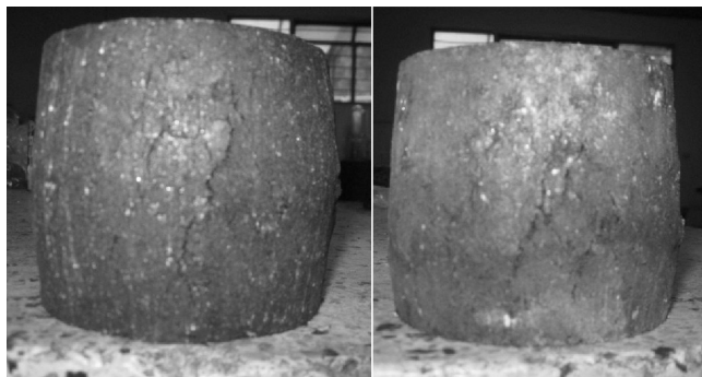
Fotografía 4.1.4 Muestras del ensayo de Inmersión - Compresión.
