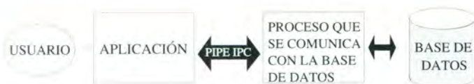
Figura 3. Forma tradicional de solicitudes a la base de datos por un proceso de usuario comunicándose con un proceso que provee el "servicio".
