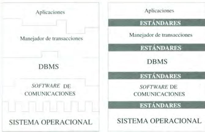
Figura 2. Interrelación entre los componentes de un sistema software tradicional vs un sistema abierto (nótese las interfaces estándar entre los componentes).
