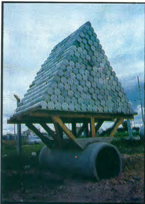
Tubo rígido TITAN® de 60 cm. de diámetro por 2 m. de longitud, bajo carga de 11.5 toneladas, sin soporte lateral.
