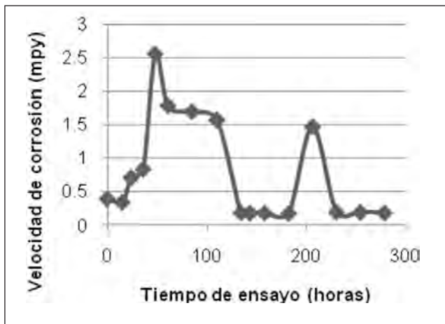
Figura 8. Variación de la velocidad de corrosión con el tiempo.
