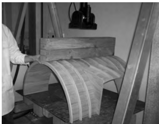
Figura 9. Disposición geométrica y de aplicación de carga de los modelos a escala de secciones de la bóveda de San Ignacio.
