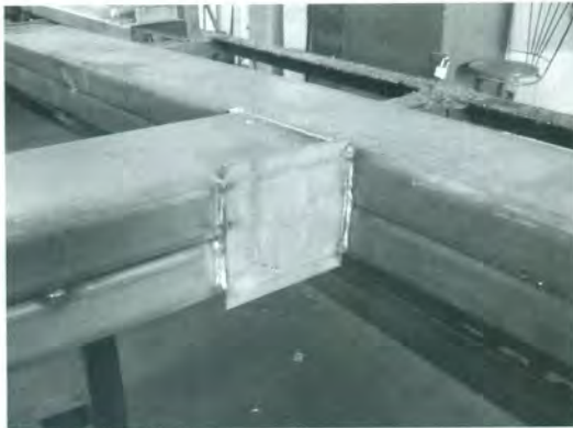
Figura 20. Fabricación. Detalle platina de asiento.
