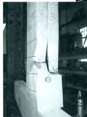
Figura 32. Pandeo local de los patines no arriestrados en sección I. Se observa el desplazamiento de la falla por la presencia de platinas de asiento.
