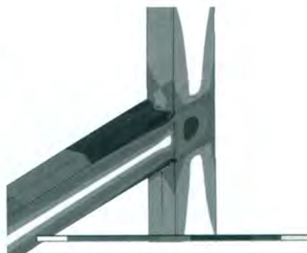
Figura 4. Esfuerzo de Von Mises. Modelo 5. Análisis elástico.
