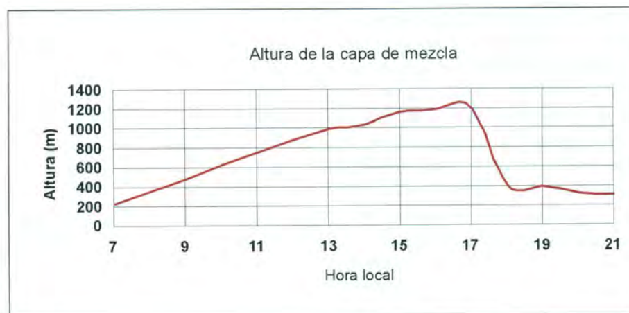
Figura 3. Altura de la capa de mezcla en función de la hora local [4] .
