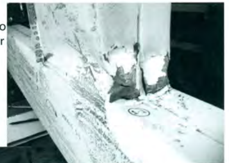
Figura 31. Pandeo del patín entre soldaduras. Zona de mayor momento.
