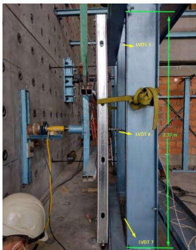
Fotografía 4. Ensayo a flexión fuera del plano instrumentación MCS-1.
