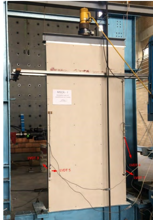
Fotografía 1. Instrumentación de ensayos a compresión.
