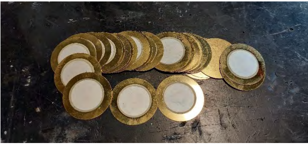
Figura 14. Discos piezoeléctricos para las pruebas de la máquina.
