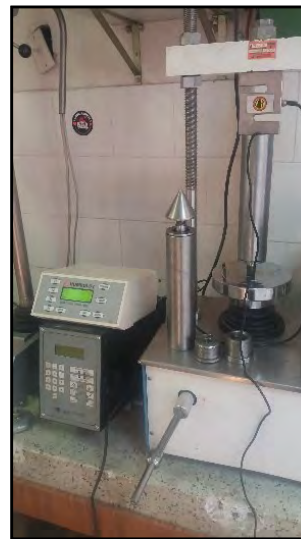
Figura 9. Calibración del cono instrumentado (Laboratorio de Ingeniería Civil de la Universidad Distrital Francisco José de Caldas).
