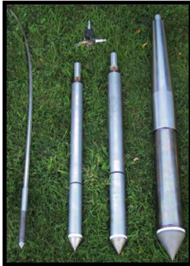
Figura 10. Rango de tamaños de conos en el ensayo CPT (2 cm 2 , 10 cm 2 , 15 cm 2 , 40 cm 2 ).
