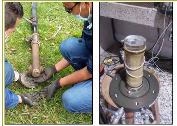
Figura 13. Toma de muestra tipo Shelby en el sitio de investigación 1 (Escuela) y ensayo triaxial UU en el Laboratorio de Ingeniería Civil de la Universidad Distrital Francisco José de Caldas.
