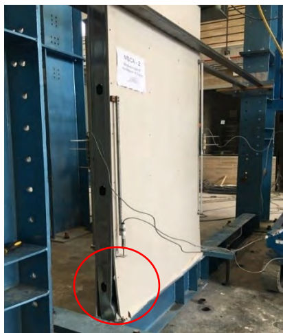
Fotografía 3. Pandeo local del montante.
