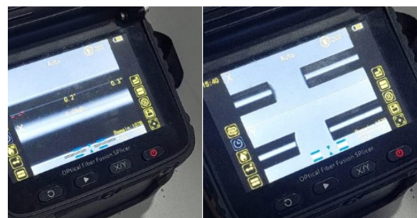
Figura 4. Calibración de la distancia y fusión de fibra óptica.
