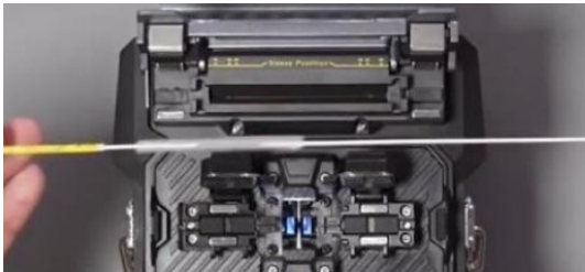
Figura 5. Protección del empalme.
