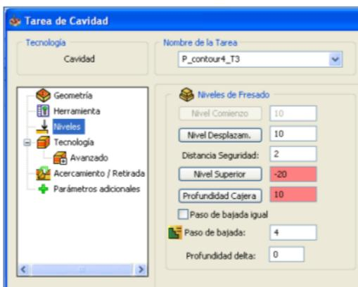
Figura 35. Niveles – Operación cavity II
