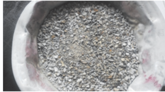
Figura 4. Muestra de agregados finos reciclados de concreto carbonatados (ARC), sobre los cuales se aplicó una solución de fenolftaleína. El no cambio de color indica las zonas carbonatadas (tomado de Ensayos de Laboratorio ECI).
