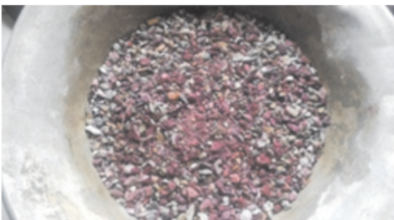
Figura 3. Muestra de agregados finos reciclados de concreto sin carbonatar (ARSC), sobre los cuales se aplicó una solución de fenolftaleína. El cambio de color rosado indica las zonas no carbonatadas. Se observa la presencia de granos carbonatados, producto de la carbonatación atmosférica de los cilindros viejos con los que se trituró este material (tomado de Ensayos de Laboratorio ECI).
