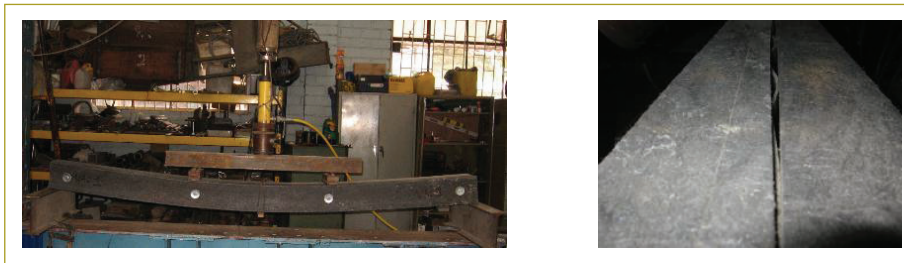
Figura 14. Falla típica en vigas acopladas sometidas a flexión, pandeo local de la lámina metálica.
