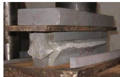
Figura 3. Falla típica de bloque Brickarp® en ensayo a compresión.
