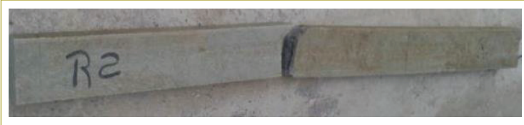
Figura 12. Falla típica de viguetas sometidas a flexión, muestra R2.
