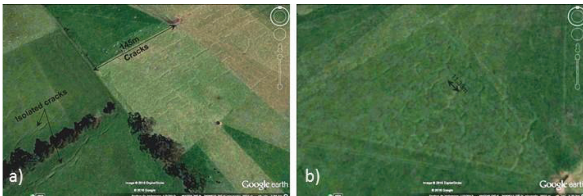
Figura 4. Fisuras de desecación de la sabana de Bogotá. a) Vista satelital de fisuras aisladas. b) Vista satelital de fisuras interconectadas. Tomado de Google Earth, 2016.
