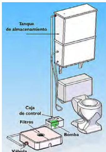
Figura 5. Sistemas hidráulicos con reúso del agua.
