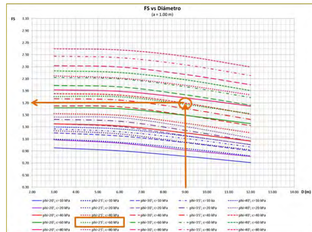
Figura 10. Ábaco Carga de enfilajes vs. Diámetro, para a = 0,5 m, F = 2 y p_f = 50 kPa.
